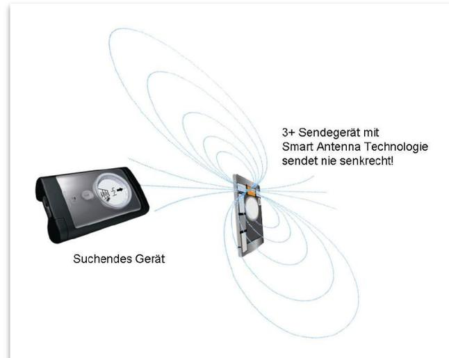
**Abbildung 20: Smart Antenna Technologie (Ortovox, 2010, S. 7)**
